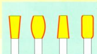
Diese Zahnflanken schleift die Woodtronic CNC 6F in einer Aufspannung. Die Schleifzonen sind rot markiert
