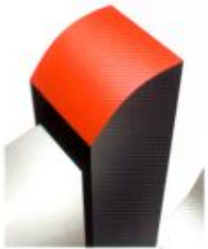
Rücken mit 1. und 2. Freiwinkel
