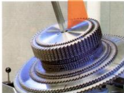
Stapelung der HM-Kreissägeblätter in beliebiger Folge. So ist Nachschärfen wirtschaftlich
